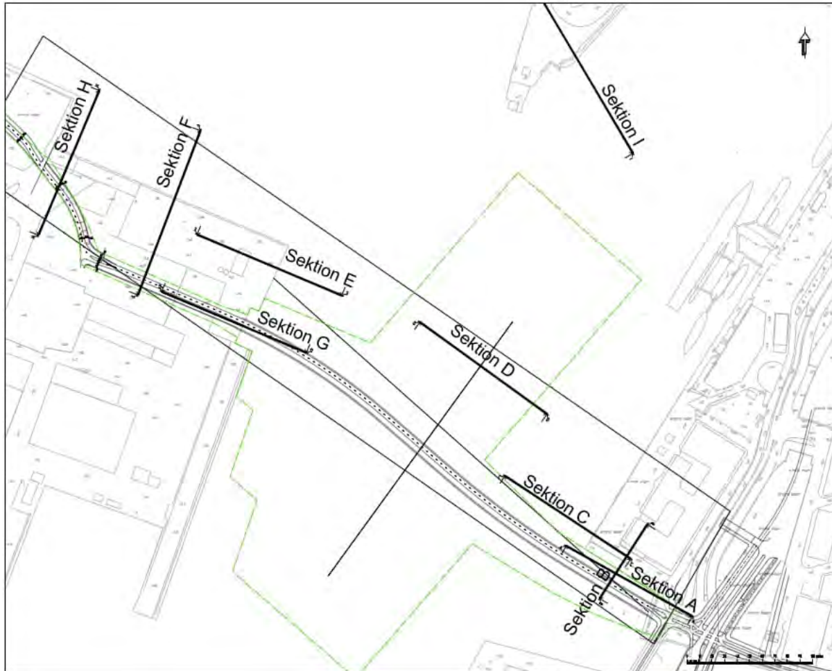
Figur 19. Översiktsplan för sektioner där stabilitetsberäkningar har utförts
