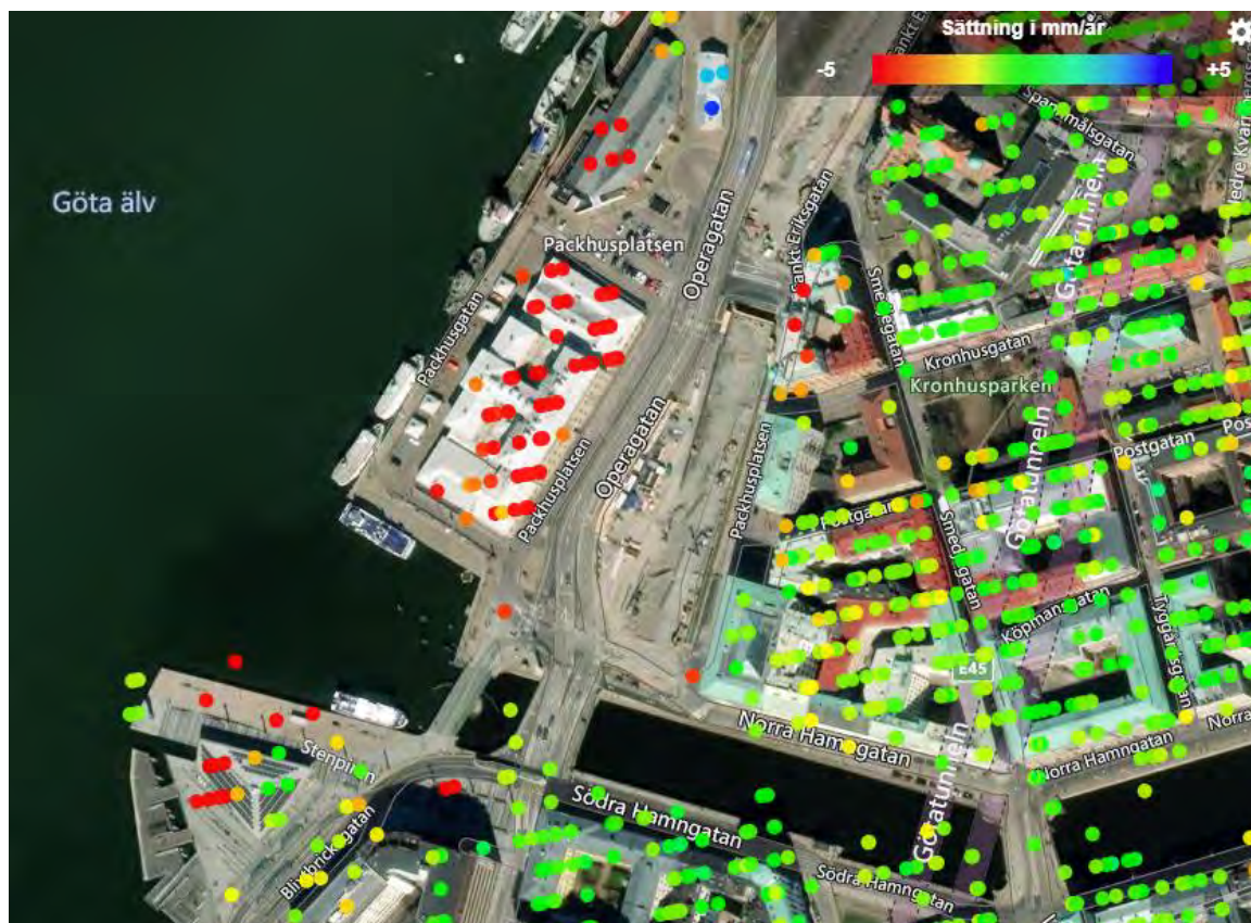
Figur 39. Kartbild med färgkodade punkter visande storleken för pågående sättningar inom Packhuskajen, skala från -5 till +5 mm/år. Den beräknade rörelsehastigheten baseras på punkternas sättningsrörelser under perioden mars 2017 till mars 2021. Hämtad från sättningskartan 2023-09-11.
